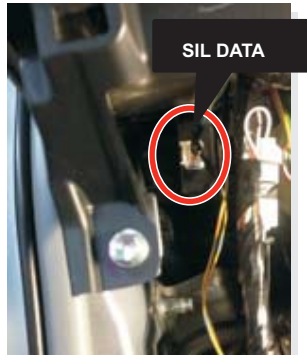
TPMS module next to driver side fuse box Module TPMS à côté de la boîte à fusibles côté conducteur
