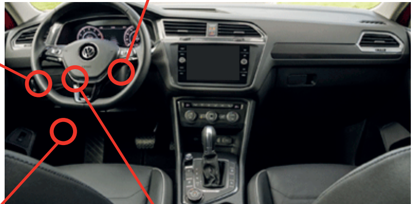
⑥ harness coming from drivers door, located in drivers kick panel. harnais provenant de la porte côté conducteur, situé dans le panneau latéral côté conducteur.
