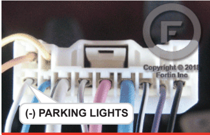
③ At Parking light switch harness Au Harnais des feux de stationnement
