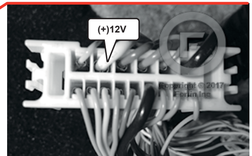
① BCM White 15-Pin connector BCM Connecteur Blanc de 15-pins
