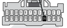
③ Grey 24-Pin connector, back view. Autolight Shutdown. Connecteur Gris de 24-pins, vue de dos. Fermeture des lumières automatiques.
