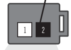
⑨ Black 2-Pin connector, back view. Connecteur Noir de 2-pins, vue de dos.
