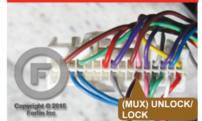
④ BCM High connector above driver kick panel BCM connecteur du haut au-dessus du panneau latéral côté conducteur
