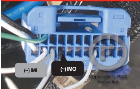
② Left of dash fusebox À gauche de la boîte à fusibles du tableau de bord
