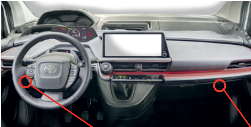
① ECU, right of dash fuse box ECU, à droite de la boîte à fusibles dans le tableau de bord
