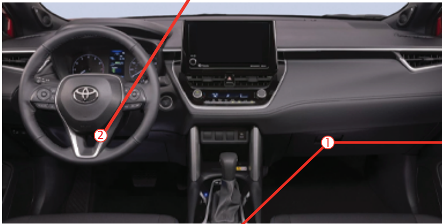
①C ECU, behind glove box ECU, derrière le coffre à gant
