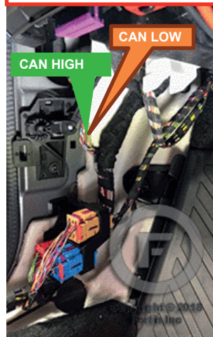
⑥ Driver's kick panel harness Harnais provenant de la porte côté conducteur
