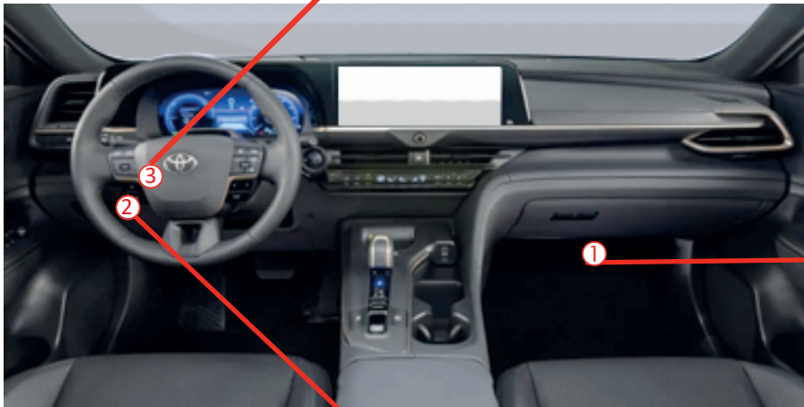
② Hybrid Vehicle Control ECU right of dash fuse box. ECU de commande de véhicule hybride à droite de la boîte à fusibles du tableau de bord.
