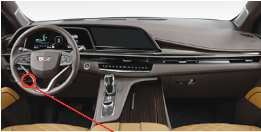
① BCM, at center consoler, on passanger side BCM, à la console centrale, côté passager
