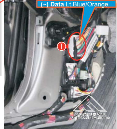
1 Drivers-side kick panel. Panneau Latéral côté Conducteur
