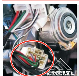
Ignition connector Connecteur Ignition
